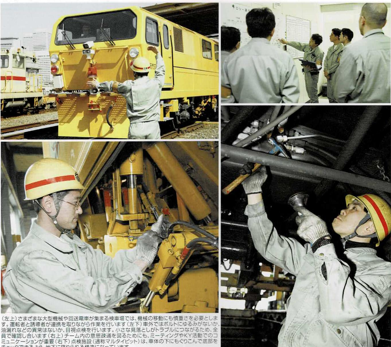
(左上)さまざまな大型機械や回送電車が集まる検車場では、機械の移動にも慎重さを必要とします。運転者と誘導者が連携を取りながら作業を行います(左下)車外ではボルトにゆるみがないか、油漏れなどの異常はないか、目視点検を行います。小さな見落としがトラブルにつながるため、全員で確認し合います(右上)チーム内の意思疎通を図るためにも、ミーティングやKY活動でのコミュニケーションが重要(右下)点検施設(通称マルタイピット)は、車体の下にもぐりこんで底部をチェックできるよう、地下に降りられる構造になっています
