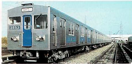
▲7000形を継承したステンレス製の30系車両
