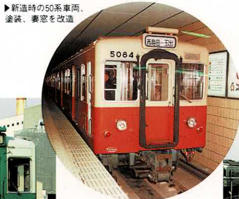
◀代表的な鋼製車両で、初の完全2両ユニットの50系車両
