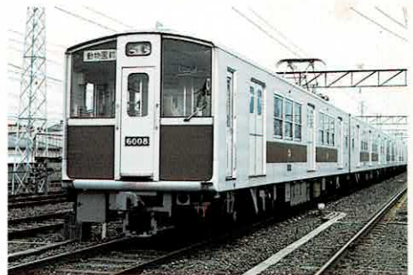
▲阪急線との相互直通運転のため、唯一のパンタグラフ方式の60系車両
