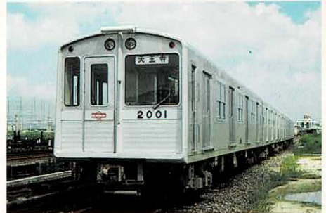
▲第三軌条方式初のサイリスタ・チョッパー車の20系車両、10系車両の前身で試験走行で終わる
