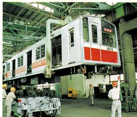
▲台車と車体を切り離して分解手入れする全般検査
