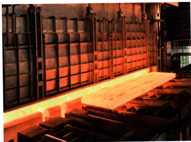
新設したNo.2加熱炉
