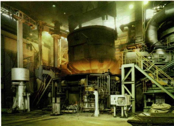
直流化された新電気炉
