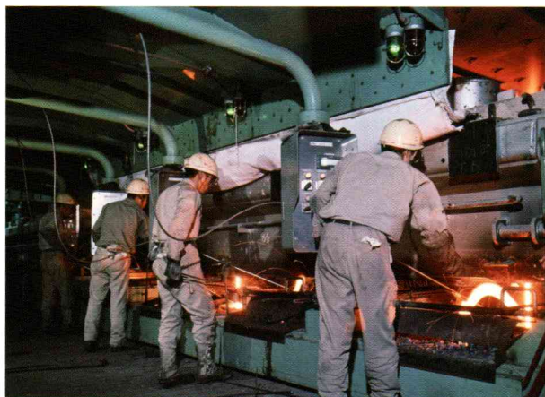
新設したブルーム連続铸造設備
